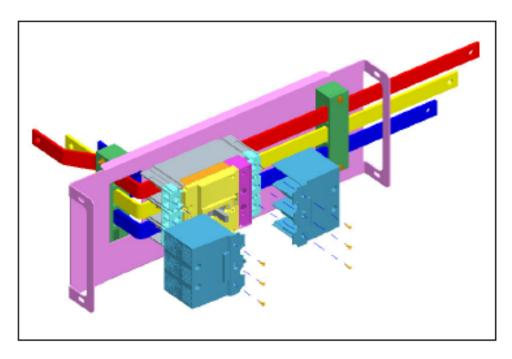
**Действие:** Ослабьте винты клеммных защитных крышек со стороны линии и нагрузки и снимите их, как показано на картинке выше.
