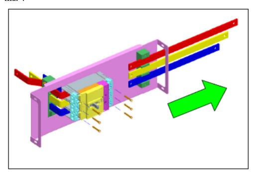
**Действие:** Выдвиньте шины со стороны линии вправо относительно выключателя, как показано на картинке выше.
