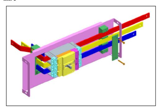
**Действие:** Ослабьте винт крепления шин со стороны нагрузки, как показано на картинке выше.
