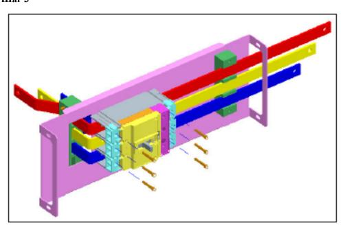
**Действие:** Ослабьте винты шин со стороны линии и нагрузки, как показано на картинке выше
